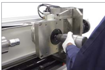
測定部は90°可動でき、シャーレンチでの作業がやりやすくなりました。ピンテール破断時の破壊トルクまで試験します。
