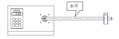
(場合により角型ビット固定ネジで水平になるように調整してください)
