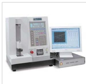
圧縮ばねの特性試験に加え、横力データの測定が可能になるユニットです。X方向とY方向にそれぞれ2個のロードセルを配置し、X方向とY方向の力から合力の横力と作用角度の測定に併せてZ軸回りのねじり力を同時測定します。
