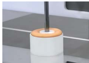
プランジャが2回試料に押し込まれます。
